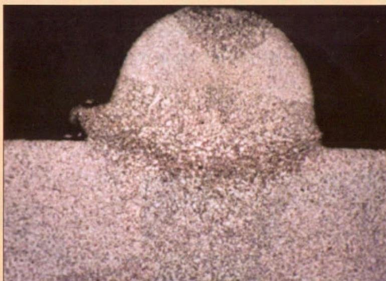
Fig. 4.4 - Giunto saldato senza gas di protezione, ingrandimento 41X
