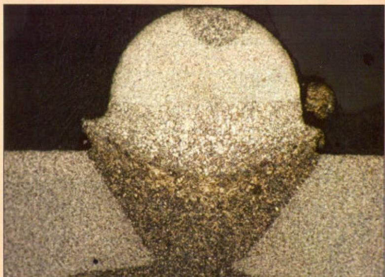
Fig. 4.3 - Giunto saldato con gas di protezione, ingrandimento 41X
