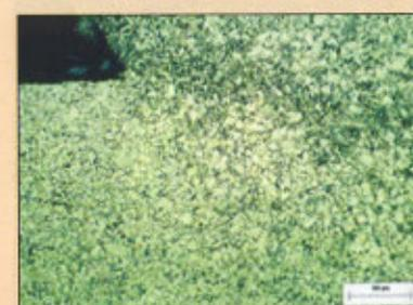
Fig.1.2 - Saldatura di barra in Titanio grado 2 senza gas di protezione
