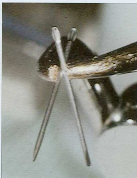
Ryc. 2. Zgrzewanie dwóch wszczepów typu igła.
