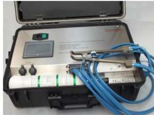
Il processo di saldatura è ottenuto da un arco elettrico. Durante tale processo, attraverso passaggi interni alla pinza, due getti di gas Argon vengono soffiati sulle parti da saldare, evitandone così l'ossidazione superficiale.
